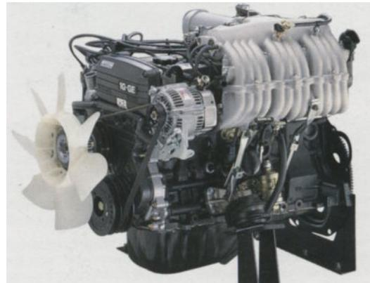
En 1982, toujours pour Toyota, Yamaha fabrique un superbe moteur 6 cylindres, d'une cylindrée de 1988 cm<sup>3</sup>, refroidi par "eau", qui développe 160 ch.
