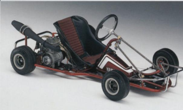
Après avoir fabriqué le RC 100S en 1973, Yamaha propose en 1975 un autre karting, le RC100M, motorisé par un monocylindre 2 temps de 98 cm<sup>3</sup>.
