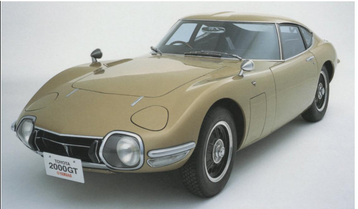
En 1966 la 2000 GT Toyota est pourvue d'un moteur Yamaha 6 cylindres, double arbre à cames en tête alimenté par trois carburateurs Solex, délivrant 150 chevaux en version standard et 200 chevaux dans sa version "racing" préparée.
