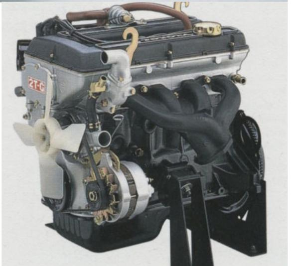
En 1970 c'est un moteur de 1588 cm<sup>3</sup>, 4 cylindres 4 temps refroidi par "eau" délivrant 115 ch. que Yamaha fournit à Toyota pour équiper la Celica 1600 GT. 30 000 moteurs seront fabriqués.
